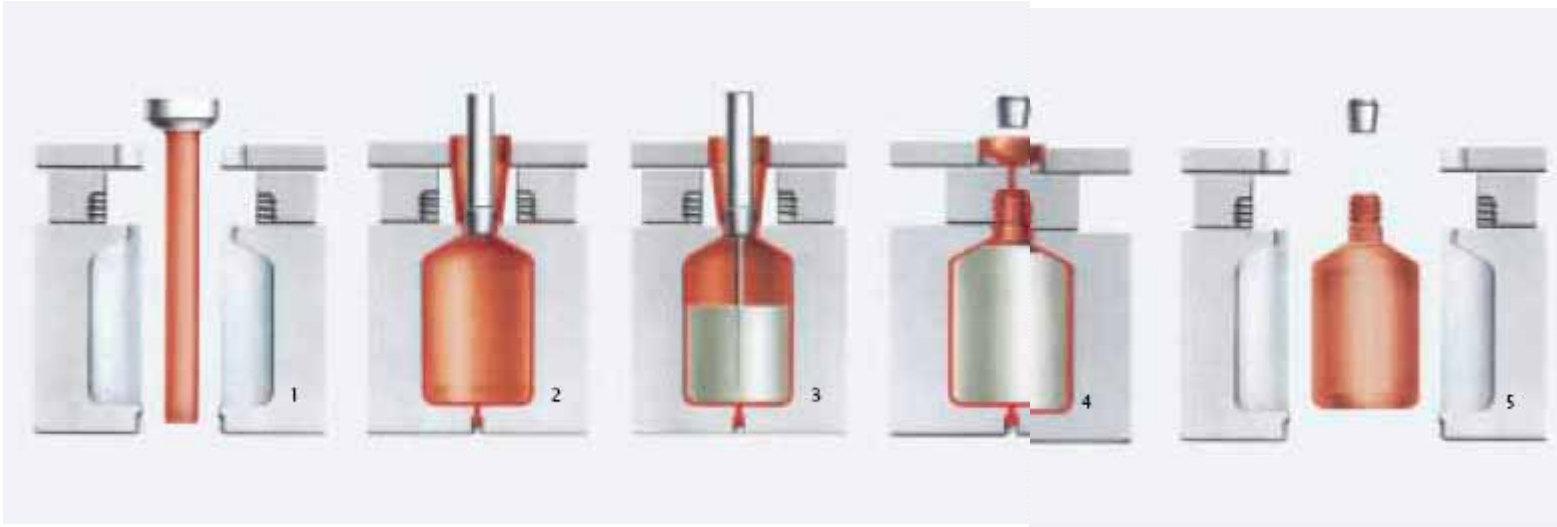
图10 吹塑充装密封工艺的原理示意图
